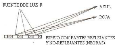
GRÁFICA. REFLEXIÓN DE LUZ ROJA Y AZUL EN ESPEJO CON REJAS DE DIFRACCIÓN 234
